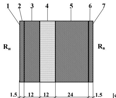
Рис. 9.15. Конструкция наружной стены 45 см
