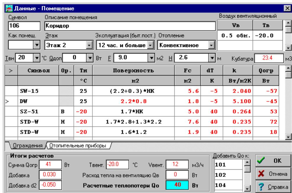
Рис. 9.28. Пример ввода данных о помещении ном. 106 - данные для расчетов теплопотерь
