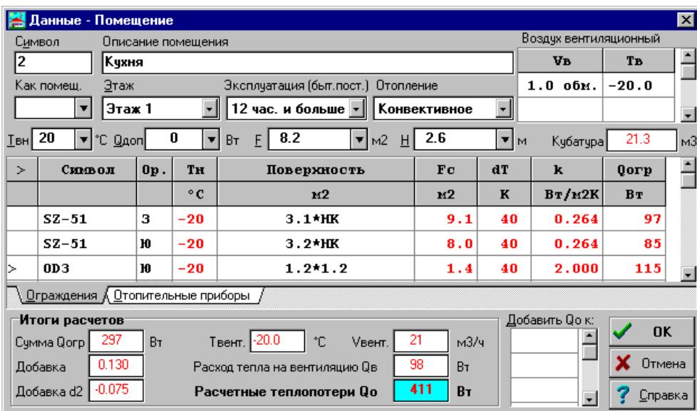
Рис. 9.26. Пример введенных данных о помещении ном. 2 - данные для расчетов теплопотерь
