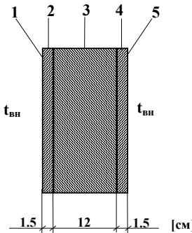
Рис. 9.13. Конструкция внутренней стены 15 см
