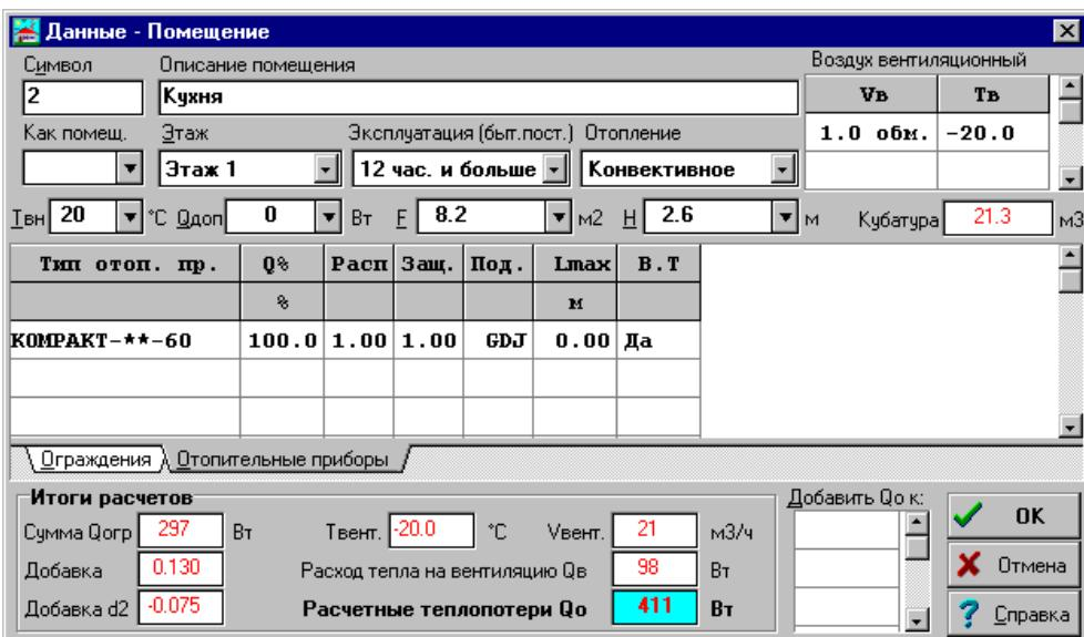
Рис. 9.27. Пример введенных данных о помещении ном. 2 - данные для подбора отопительных приборов
